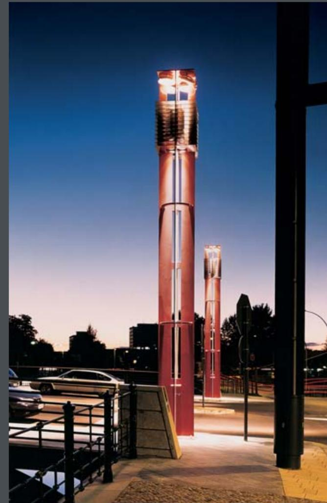
Vier acht Meter hohe Lichtmasten prägen das Erscheinungsbild der Brücke – besonders nachts, denn dann bringen vier 35 W Lampen die signalrote Farbe der Masten besonders gut zur Geltung. Für die indirekte Fahrbahn- und Fußwegbeleuchtung sorgen Sekundärspiegelfeldsysteme mit je vier 70 W Halogenmetaldampf-Strahlern der 090er-Serie – natürlich unter Beachtung der Empfehlungen zur Blendungsbegrenzung von Straßenbeleuchtungsanlagen für die Binnenschifffahrt auf Bundeswasserstraßen.
